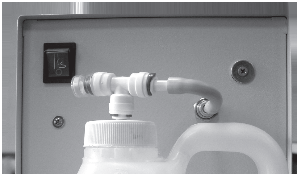
Фото 5. Крепление заборного устройства на корпусе генератора.
